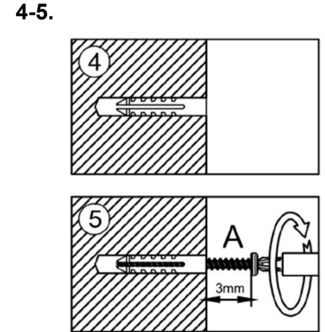
4-5. Die Platzierung der Dübel kontrollieren (muss mit der Wand eben sein). Die Schraube in Loch A festschrauben – 3 mm Luft zwischen die Wand und den Schraubenkopf lassen.
