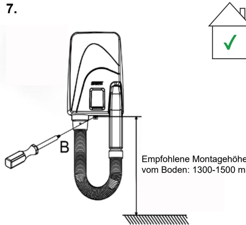
7. Die Schraube in Loch B einsetzen und festschrauben, um das Gerät an der Wand zu befestigen.
