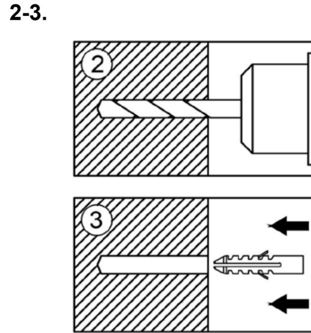
2-3. 6 mm Löcher in die Wand bohren, und die zum Wandtyp passenden Dübel in die Löcher einsetzen.
