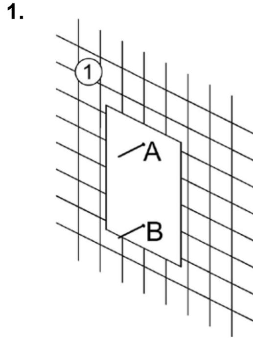
1. Bohrschablone an der Wand befestigen, und die Bohrlöcher A und B mit einem Bleistift markieren.
