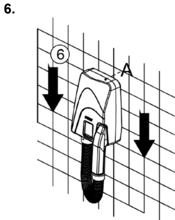
6. Der Haartrockner über Schraube A platzieren. Gerät leicht nach unten drücken und festmachen.
